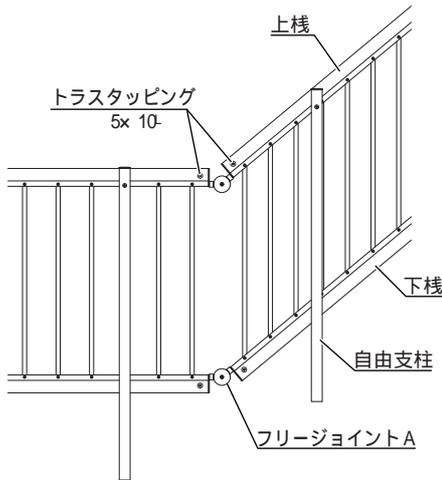
(注) フリージョイントA取付部の格子の隙間を少なくする場合は、角度に応じて上棧・下棧の端部を切断してから接続してください。
