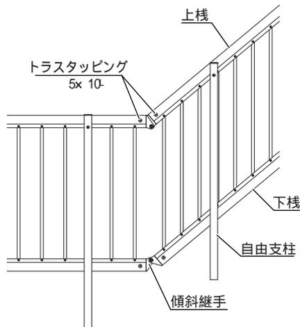
(注) 傾斜継手取付部の格子の隙間を少なくする場合は、角度に応じて上棧・下棧の端部を切断してから接続してください。
