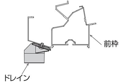
3. 裏板（柱連結金具用）を単棟側と連棟側の前枠に挿入してください。
