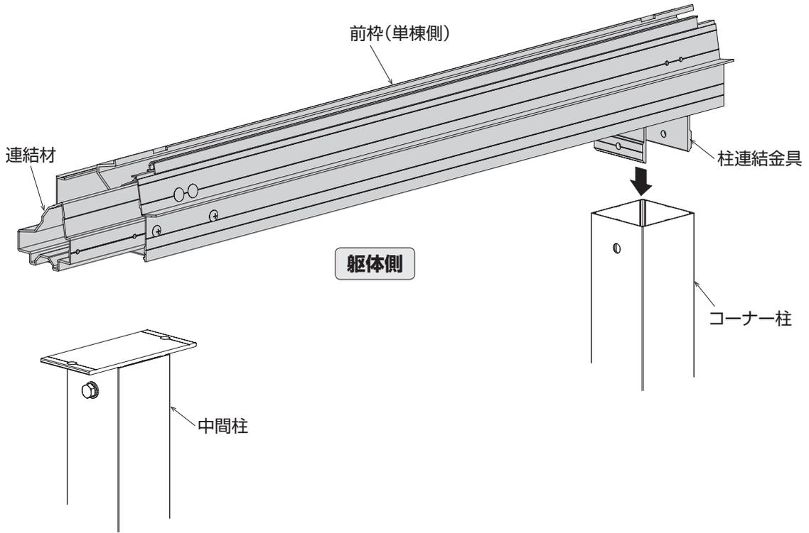
2. 単棟側の前枠を中間柱の柱連結金具に仮留めしてください。
