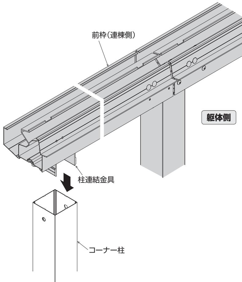
6. 連棟側の前枠を単棟側の前枠の連結材に取り付けてください。
