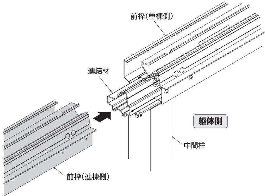
5. 連棟側の前枠の柱連結金具をコーナー柱に挿入してください。
