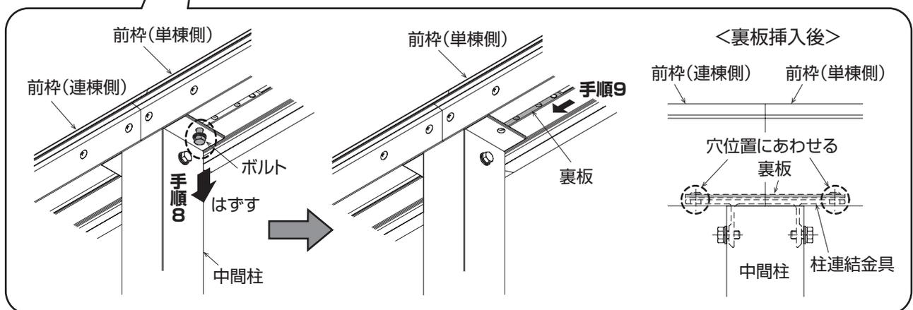
10. 単棟側と連棟側の前枠を中間柱に取り付けてください。
