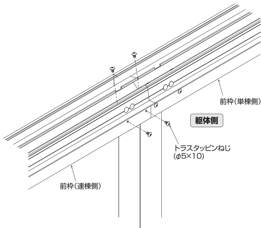
7. 単棟側と連棟側の前枠をコーナー柱に取り付けてください。
