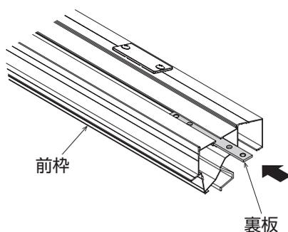
4. 柱連結金具を前枠の両端に取り付けてください。
