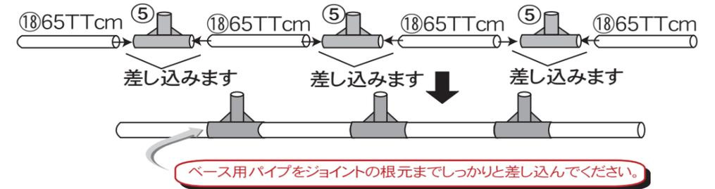
(3) 先に組み立てた各パイプをパイプジョイントで組み立てます。
